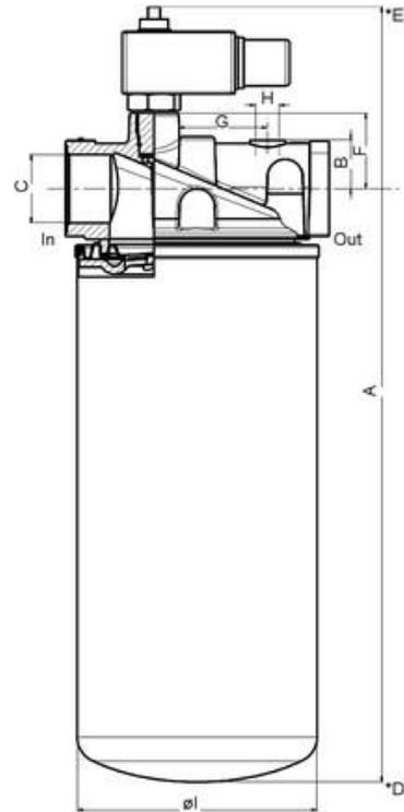
Durch Umstecken des elektrischen Schaltteiles um 180° kann die Schaltfunktion geändert werden (Öffner oder Schließer). Lieferzustand ist Öffner. Bei Induktivität im Gleichstromkreis ist der Einsatz von Löschiendern zu überprüfen. Weitere Angaben und weitere Ausführungen von Wartungsanzeigern enthält das Datenblatt Wartungsanzeiger.
